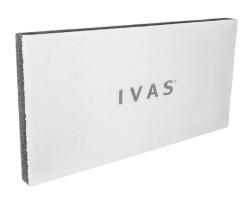
Panel aislante sinterizado-laminado de conductividad térmica mejorada idóneo para la aplicación por capas, realizado en poliestireno expandido sinterizado EPS aditivado con un mínimo del 70 % de grafito, con una superficie en EPS blanco producido por sinterización-laminación.
